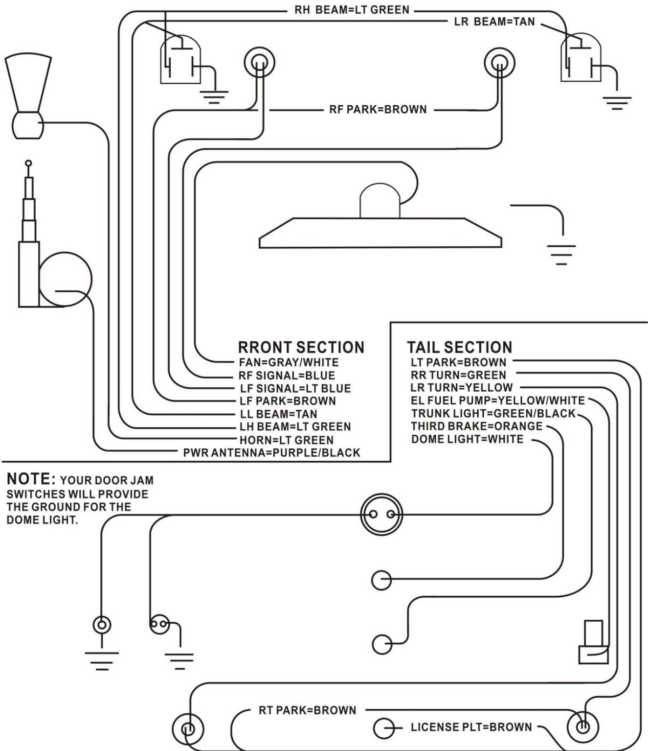
**21 CIRCUIT TAIL SECTION DIAGRAM**
